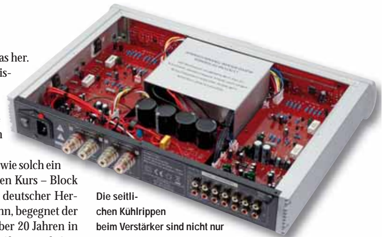
Show, auf ihnen sind die Endstufentransistoren montiert. Der stattliche Ringkerntransformator ist mit einem Blechdeckel geschirmt. Die Infrarotfernbedienung (I.) steuert die komplette Anlage
